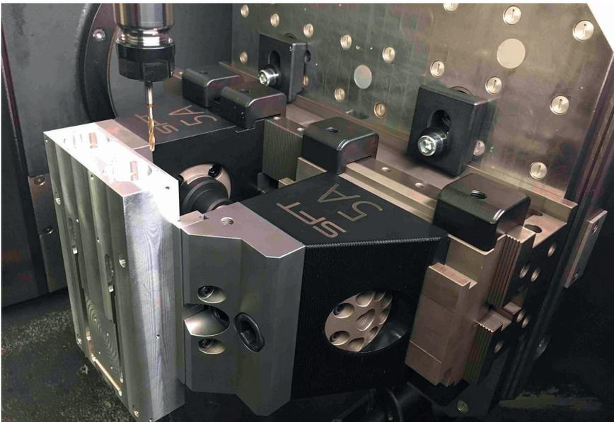
1 Der 5A-Multispanner zeichnet sich durch eine stabile, vibrationsarme Zerspanung sowie eine hohe Grundsteifigkeit aus bei einer Spannkraft von bis zu vier Tonnen © SFT
